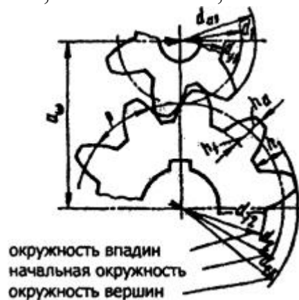
Рис. 9.18. Элементы зубчатого зацепления
